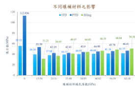
圖 17 牙本質小管無填補材料與填補七種楊氏模數分別為 15.54, 23.31, 31.08, 38.85, 46.62, 54.39 和 62.16 GPa 之材料, 承受垂直於小管方向之負載時的盟麥斯應力長條圖, 縱軸為盟麥斯應力, 橫軸為填補材料之楊氏模數, 淺藍色長條代表管間牙本質, 深藍色長條代表管周牙本質, 綠色斜線長條代表填補之材料
