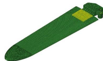
圖五 側向安定面結構網格劃分
