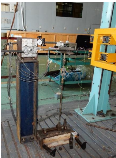
圖十 側向安定面試驗安裝圖
