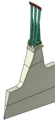
圖 1、L-1 級動葉片整體組合在一起的實體模型
