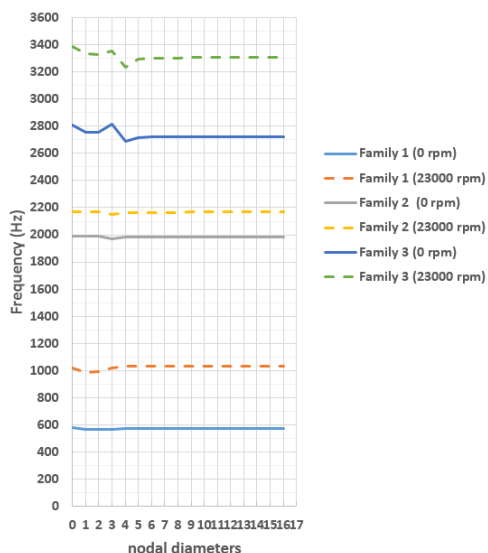
圖 5. 不同轉速下，葉片一階彎曲模態 (Family 1)、扭轉模態 (Family 2)、二階彎曲模態 (Family 3) 之節徑數與頻率關係圖
