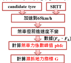
圖二：拖車或輪胎試驗用車法簡易測試流程圖。
