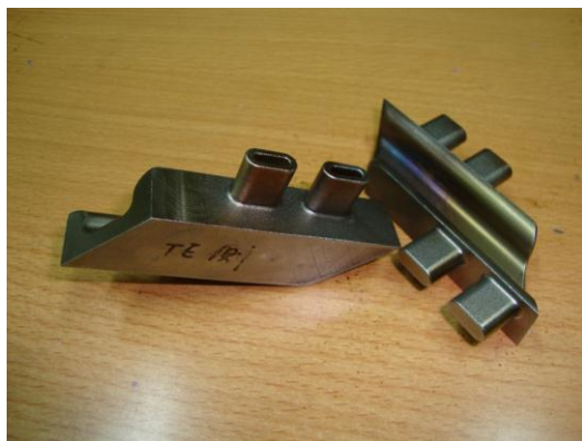
圖 4 低壓汽機末級動葉片之 cover segment
