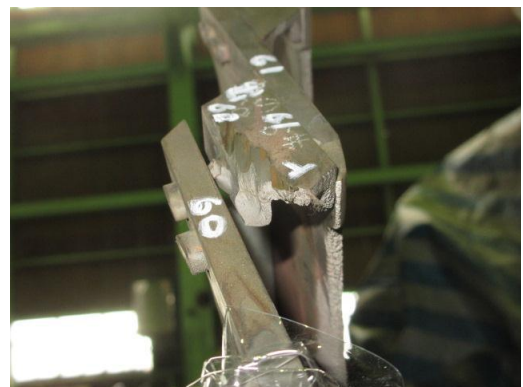
圖 2 動葉片 cover segment 龜裂
