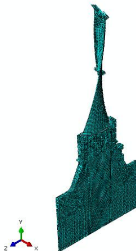
圖 8 低壓汽機末級動葉片、軸碟及轉軸的網格模型
