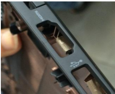
圖 1、NB IO port 橋接部分
