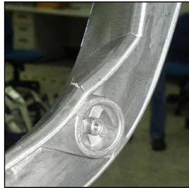
圖 2 底座壓縮測試的破裂狀況
