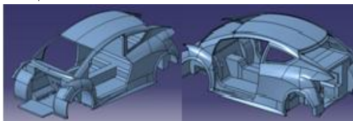
圖 3 Green Jumper 車體結構 系統化複材結構設計及最佳化
