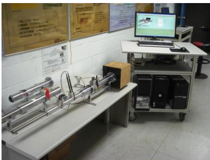
圖 8 ARTC 聲學阻抗管量測設備
