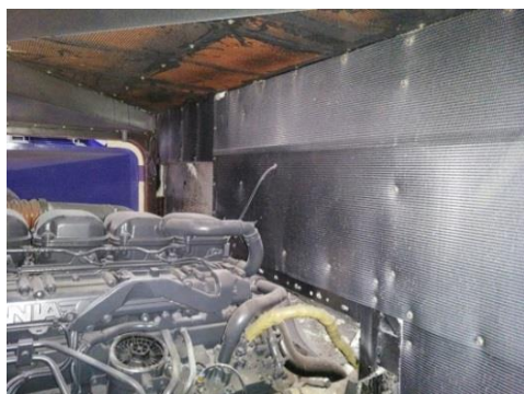
圖 16 吸隔音材新組件裝
