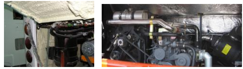
圖 1 傳統大客車引擎室之吸隔音層配置
