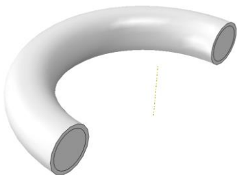
圖 1：下顎骨簡化模型，分為外層的皮質骨與內層的疏鬆骨
