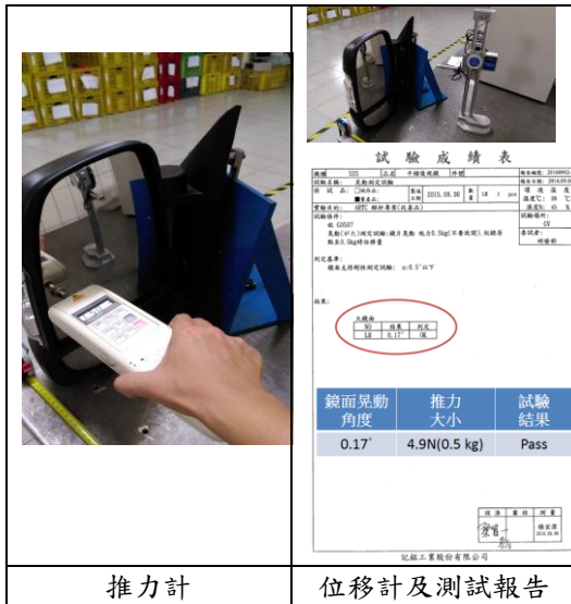
圖 12 改善設計之鏡面剛性測試結果
