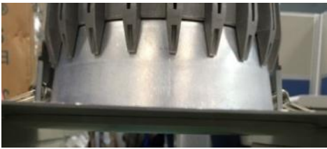
圖 11 原始彈簧在 0 次折彎時下方無間隙值
