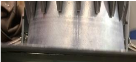
圖 12 原始彈簧在 1 次折彎時下方有間隙值
