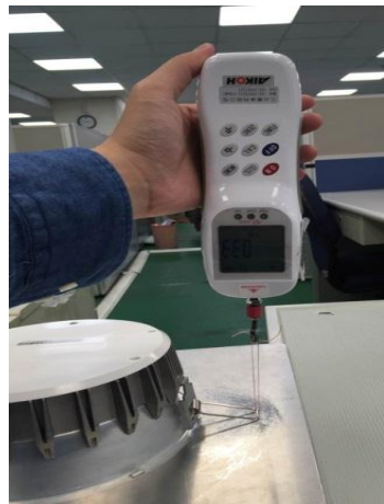
圖 10 推拉力計量測彈簧力大小
