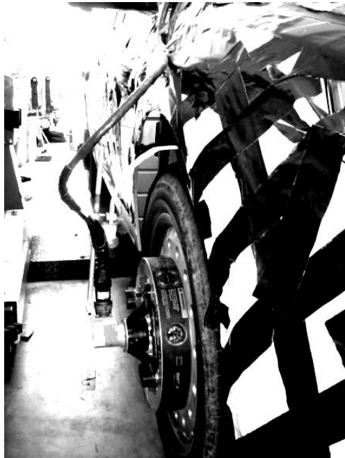
圖一 整車入力量測試之輪心量測儀器之架設狀態*
