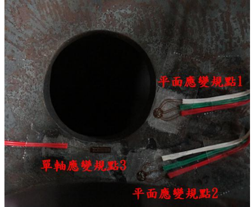
圖 4 20 吋滑輪應變規之配置
