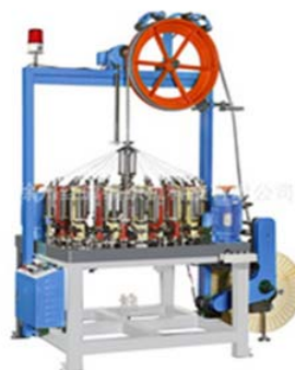
圖5 高壓軟管編織機之紗筒架的示意圖
