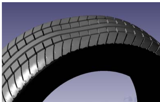
圖 7 輪胎數值模型經過 ABAQUS 變形計算
