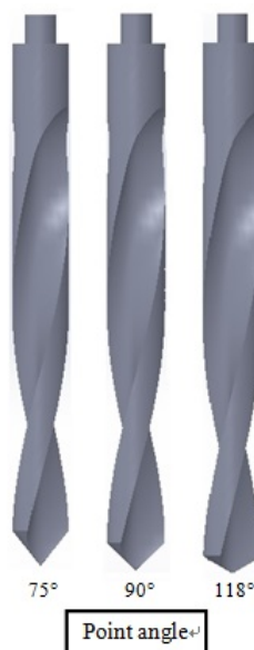
圖 1 人工植牙鑽頭之三種不同鑽頂角三維實體模型
