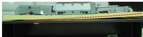
圖 10 實際落摔面板變形
