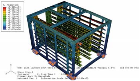
圖 11、溫昇 500 度，最大變形
