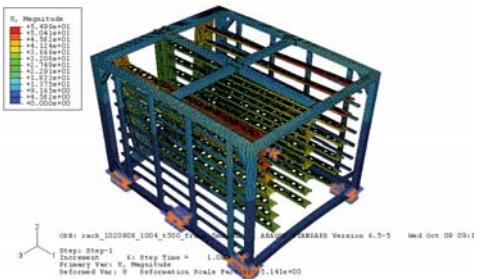
圖 11、溫昇 500 度，最大變形
