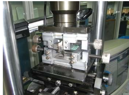
圖九 架設完成之插拔試驗機台
