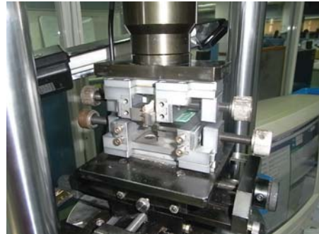
圖九 架設完成之插拔試驗機台
