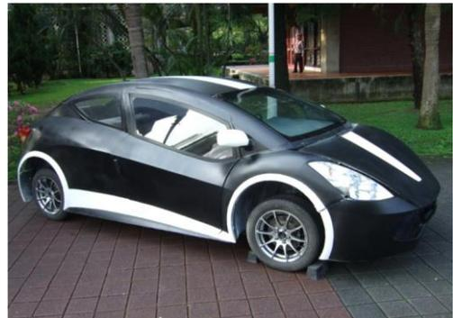
圖 1 本研究團隊自行開發製造的都會型鋰電池電動車 Green Jumper
