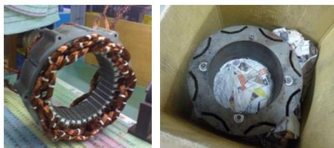
圖 2 動力馬達電磁設計之定轉子、繞線製造結果
