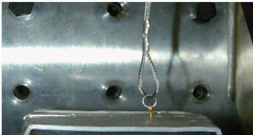
圖 17 拉環拉力試驗設置
